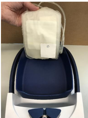
Figur 27: RFID-etikettens posisjon på den nederste posen.
