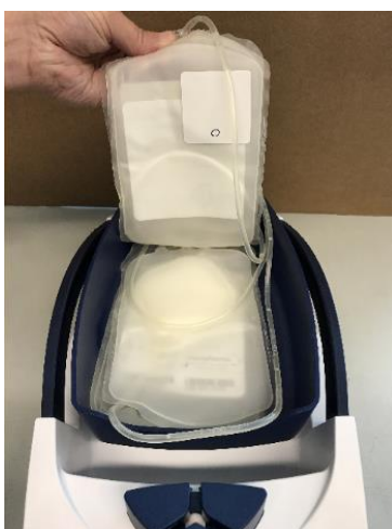
Figur 26: RFID-etikettens posisjon på den midtre posen.
